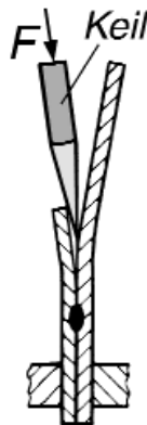
Prüfen von Punktschweißungen nach Merkblatt DSV 2916
